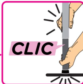
Vérifier que le pied plastique de la jambe de force est correctement en appui.
