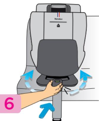
Pousser le siège au **maximum** en oscillant de droite à gauche.
